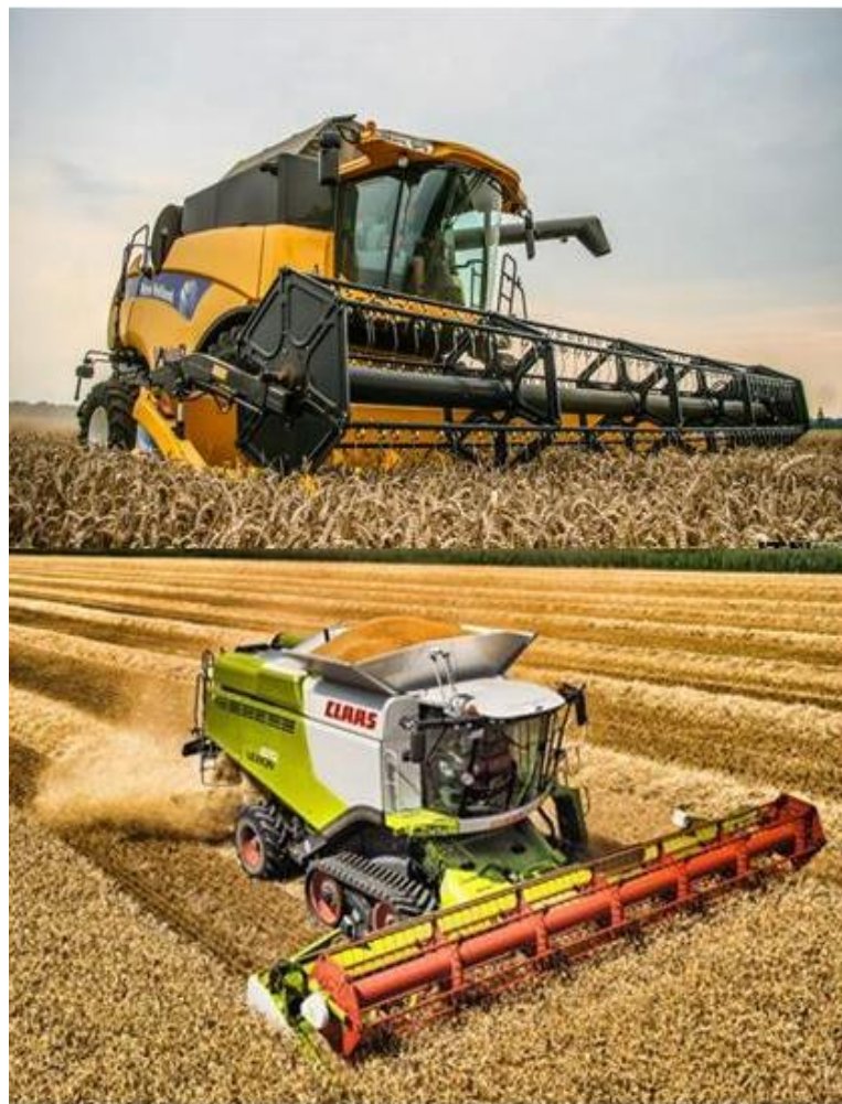
New Holland CX 8080 avec une largeur de coupe de 3.3 m (ci-dessus) et CLAAS Lexion Combine 670 avec une largeur de coupe de 12 m (ci-dessous)
