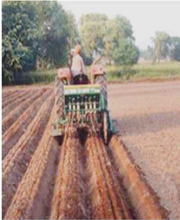
Mise en place de lits, de sillons et de rangées de plantation en un seul passage du tracteur sur un champ bien labouré et nivelé
