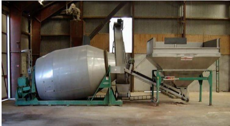
*Système rotatif utilisé dans le mélange des engrais*
