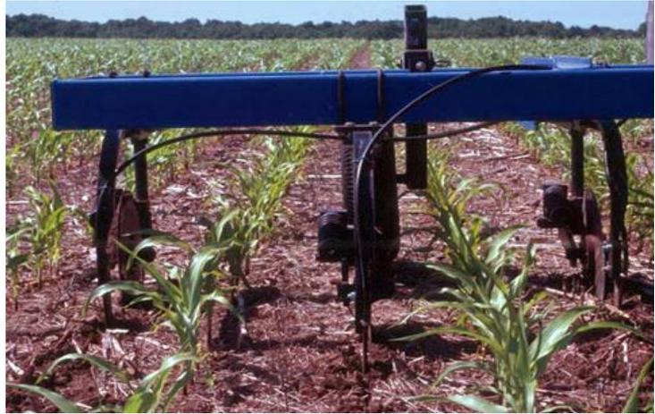
*Perceuse montée sur tracteur pour l'épandage d'azote*
