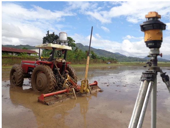
Système de nivellement du sol avec un tracteur guidé par laser
