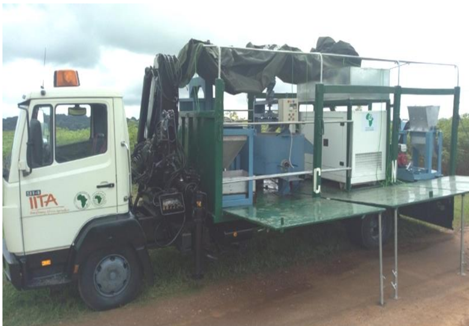
Usine mobile de transformation du manioc fabriqué en Nigeria
