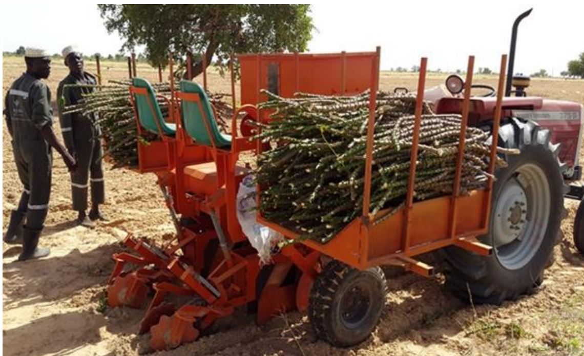
La planteuse de manioc à deux rangs modèle 2AMSU en cours de préparation pour les opérations au Nigeria
