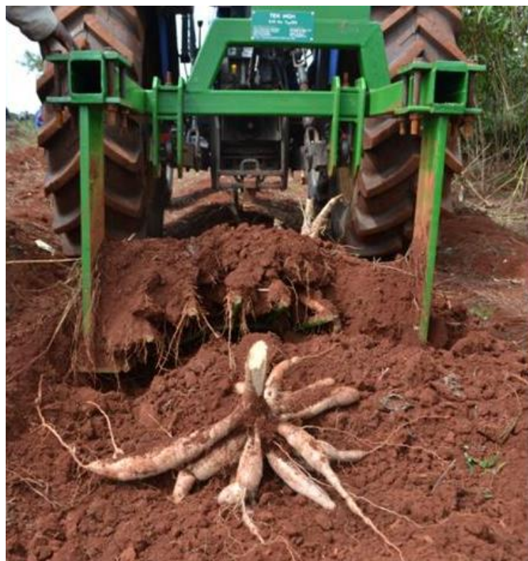
Accessoires de récolte utiles pour l'arrachage des racines de manioc utilisé au Nigeria
