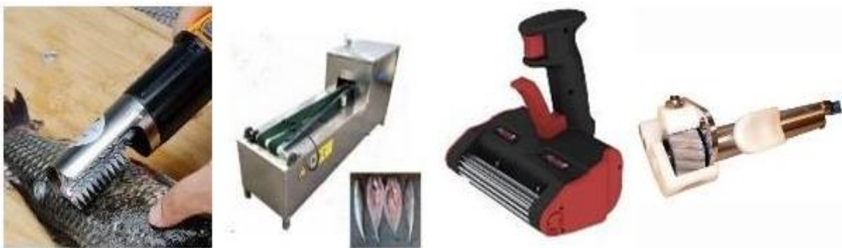
Gamme d'outils de transformation du poisson (de gauche à droite) : écailleur, coupeur, écorcheur et désosseur
