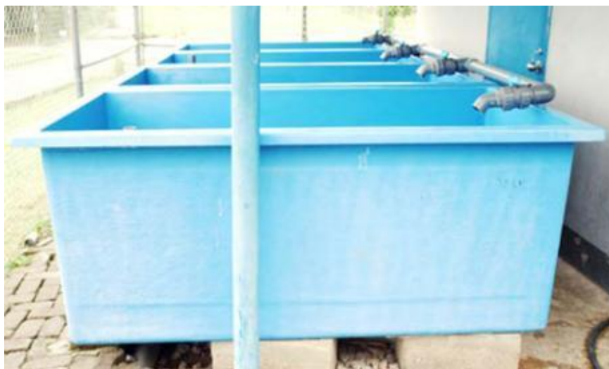
Bassins à circulation continue avec utilisation unique de l'eau
