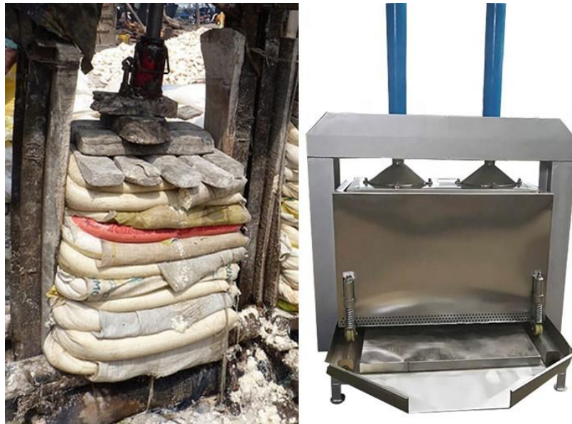
Une presse à vis en fonctionnement (à gauche) et une presse hydraulique adaptée à la production commerciale (à droite)
