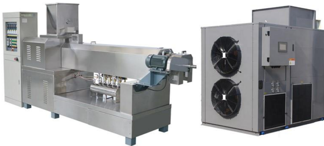
Un rouleau et un coupeur de pâtes à l'échelle industrielle (à gauche) et un four de séchage (à droite).
