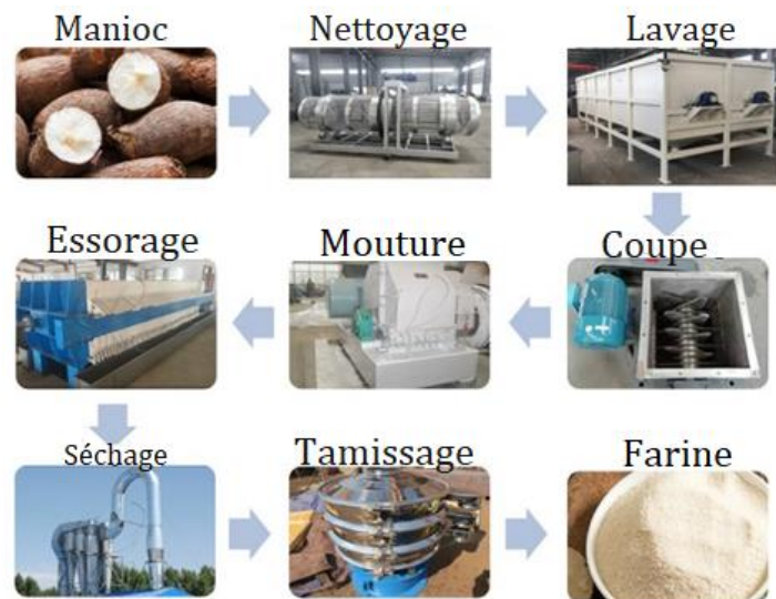
Une approche moderne de traitement industriel de la farine de manioc où toutes les opérations sont mécanisées (Crédit: cassavaprocessing.com)
