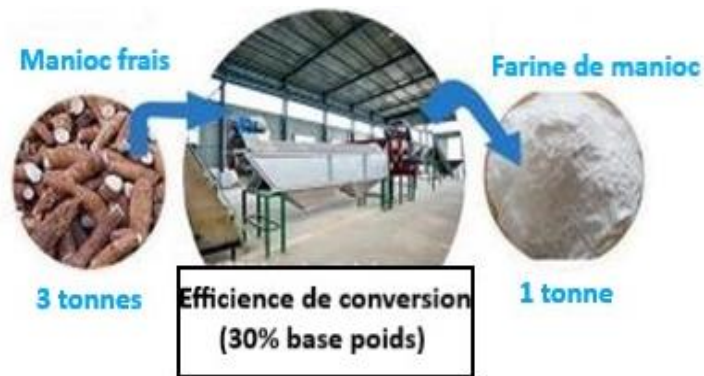
La transformation de la racine de manioc fraîche en farine de manioc de qualité supérieure
