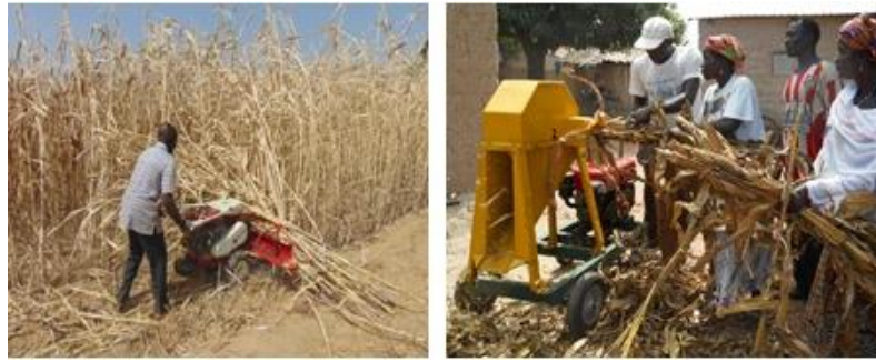
Utilisation de la coupeuse de chaumes motorisée (à gauche) et de l'hacheuse mobile (à droite)
