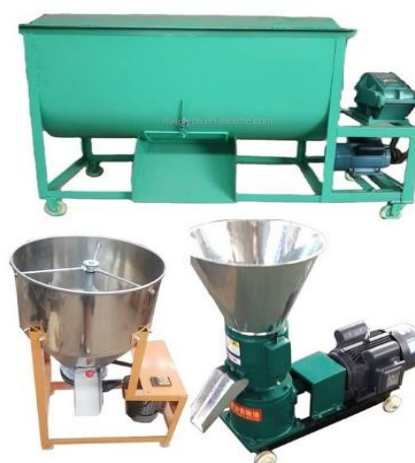
Un mélangeur horizontal (en haut), un moulin (à gauche) et une machine à granulés (à droite) utilisés dans la production d'aliments à petite échelle
