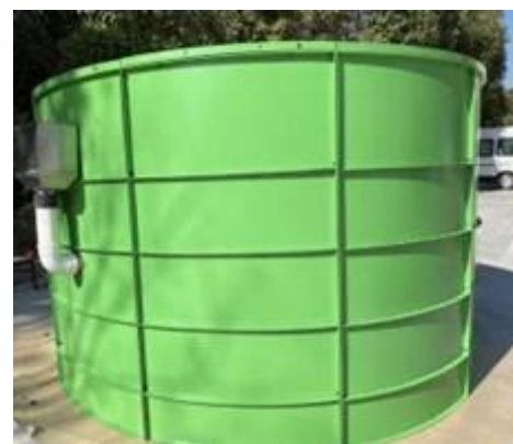
Digesteur discontinu pour la production de biogaz à partir de fumier de volaille
